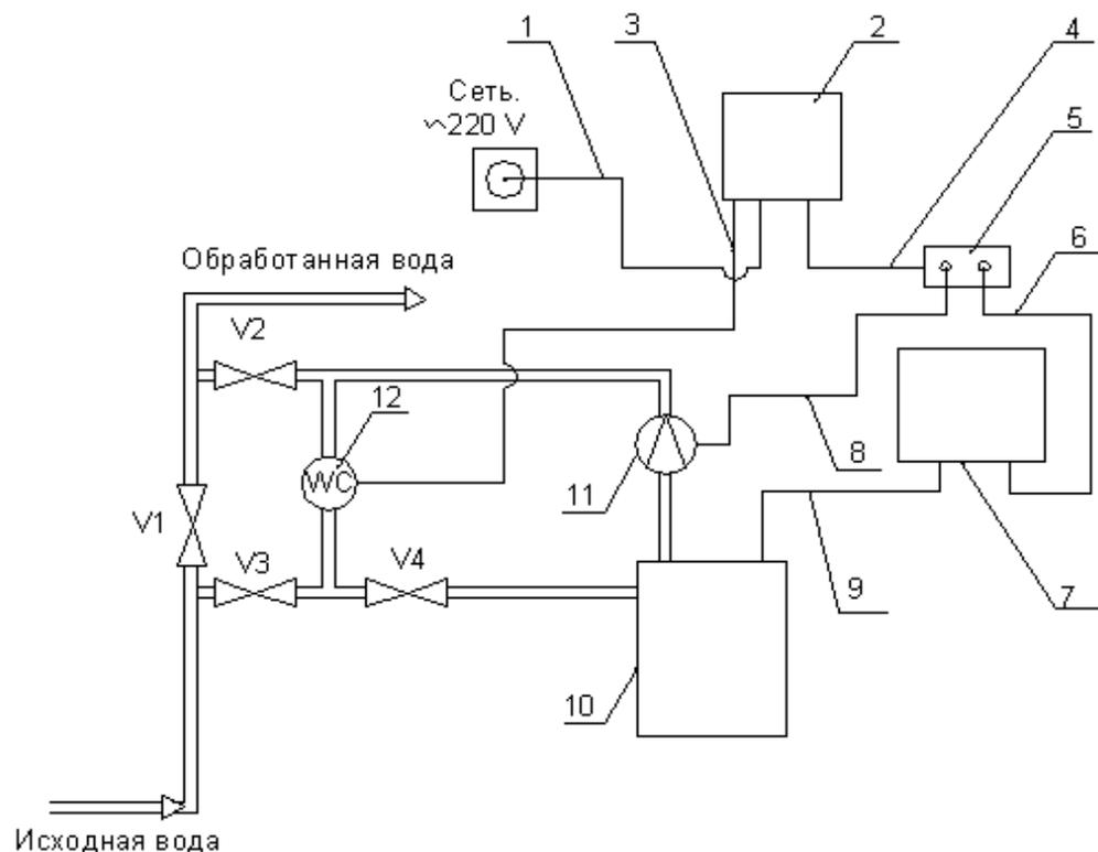
**Схема подключения Санатора в комплексе с микроконтроллером МПВ<sup>PRO</sup> и дозирующим насосом Stenner:**
